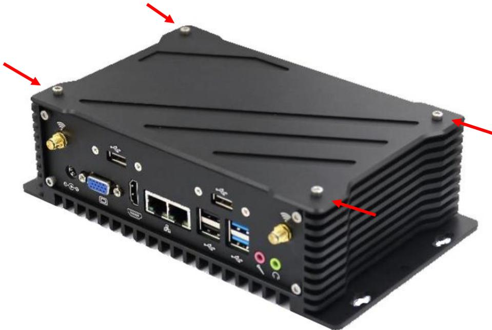
2. Pour retirer le module Quectel (où les antennes sont fixées), une vis noire doit être desserrée.
